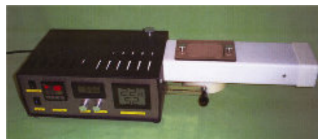
Slika 1: PERMETEST – Uređaj za nedestruktivno određivanje otpora prolazu topline i otpora prolazu vodene pare, tt. Sektora Instruments [17]
