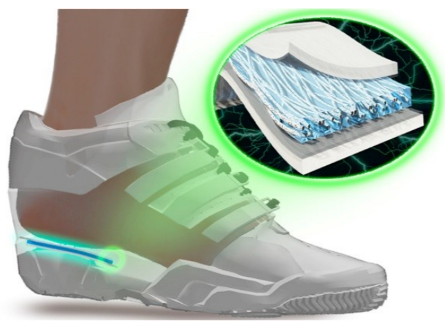
Slika 3: Elektrospredeni nanokompozitni generator ugrađen u tenisicu [13].
