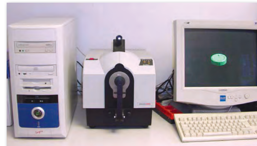
Slika 2: Remisijski spektrofotometar Spectraflash SF 600 PLUS-CT
