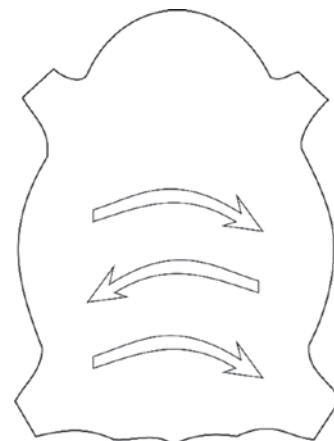
Slika 8. Smjerovi krojenja na cijelim kožama mladih životinja bez karakteristične leđne linije
